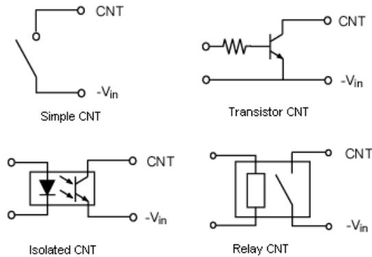
Fig. 51 CNT Circuit
