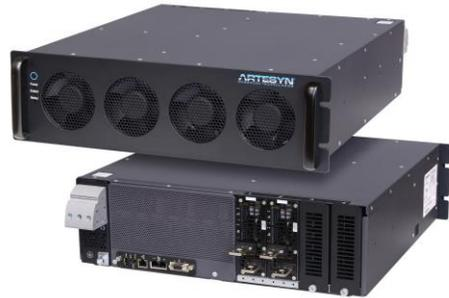
這款模組式電源系統適用於多種不同的醫療設備和工業製品，可為這些應用提供一個可程式設定的電壓或電流源，其輸出的準確性、解析度和穩定性都符合要求。由於雅特生科技的 iHP 系列電源產品已取得多個安規認證，因此採用這系列產品的醫療設備無需加設隔離式變壓器。此外，iHP 系列電源系統也獲發多個適用於工業生產的安規認證，符合適用於半導體製程設備的 SEMI F47 電壓驟降容忍度規定。
