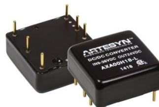
Artesyn AXA シリーズのモジュールは 9~36VDC と 18~75VDC の 4:1 広入力電圧範囲に対応しています。最初に販売されるモデルは電圧 3.3、5、12、15 および 24V の単一出力モデルと +/- 12 または +/- 15 のデュアル出力モデルで、すべての厳しい出力電力規制に適合しています。1.0 x 1.0 x 0.4 インチ (25.4 x 25.4 x 10.16 mm) のパッケージで Artesyn AXA シリーズは最高 89% の効率を提供します。
