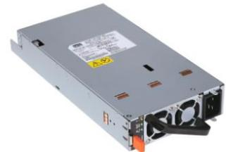
DS2500PE-3 電源可為下游的直流/直流電源轉換器提供 12V（直流）的主有效載荷輸出和 208A 的電流，也可為電源管理電路提供 3.3V（直流）的停備輸出電壓（額定輸出電流為 2.7A）。雅特生科技的這款 DS2500PE-3 電源外型小巧，大小只有 11.56 x 5.47 英寸（293 x 139mm），1U 高（1.689 英寸或 43mm），效率最高可達 94%。
