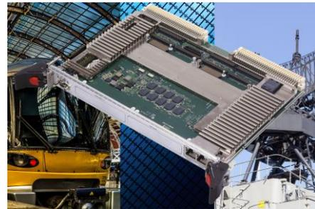
MVME8105 单板计算机内置主频为 2.0 GHz 的飞思卡尔 (Freescale) QorIQ<sup>TM</sup> P5020 处理器，另外搭配 4GB 贴片焊接的 DDR3-1333 MHz ECC 内存、512 K MRAM 非易失性存储器和 8 GB eMMC NAND 闪存。此外，这款单板计算机还配备多种接口，如：USB、串口和以太网，而且可以支持多种操作系统，其中包括风河 (Wind River) 的 VxWorks、Linux 和 Green Hills 的 Integrity。
